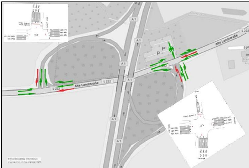
Rechnerisch sind die Doppelspuren vor/nach den Einmündungen der BAB-Rampen nur soweit erforderlich, um eine sinnvolle Verflechtung bzw. Einordnung der pro Ampelphase ankommenden Fahrzeuge zu ermöglichen. Da in [2] ein Ausbau der Kreuzung L 222/Ahrensburger Weg/Groot Redder bzw. der 4-spurige Ausbau der L 222 vom Hamburger Stadtgebiet bis zur Landesgrenze als künftig erforderlich beschrieben wird, sollte eine durchgehende Umsetzung der Vierspurigkeit angestrebt werden.
