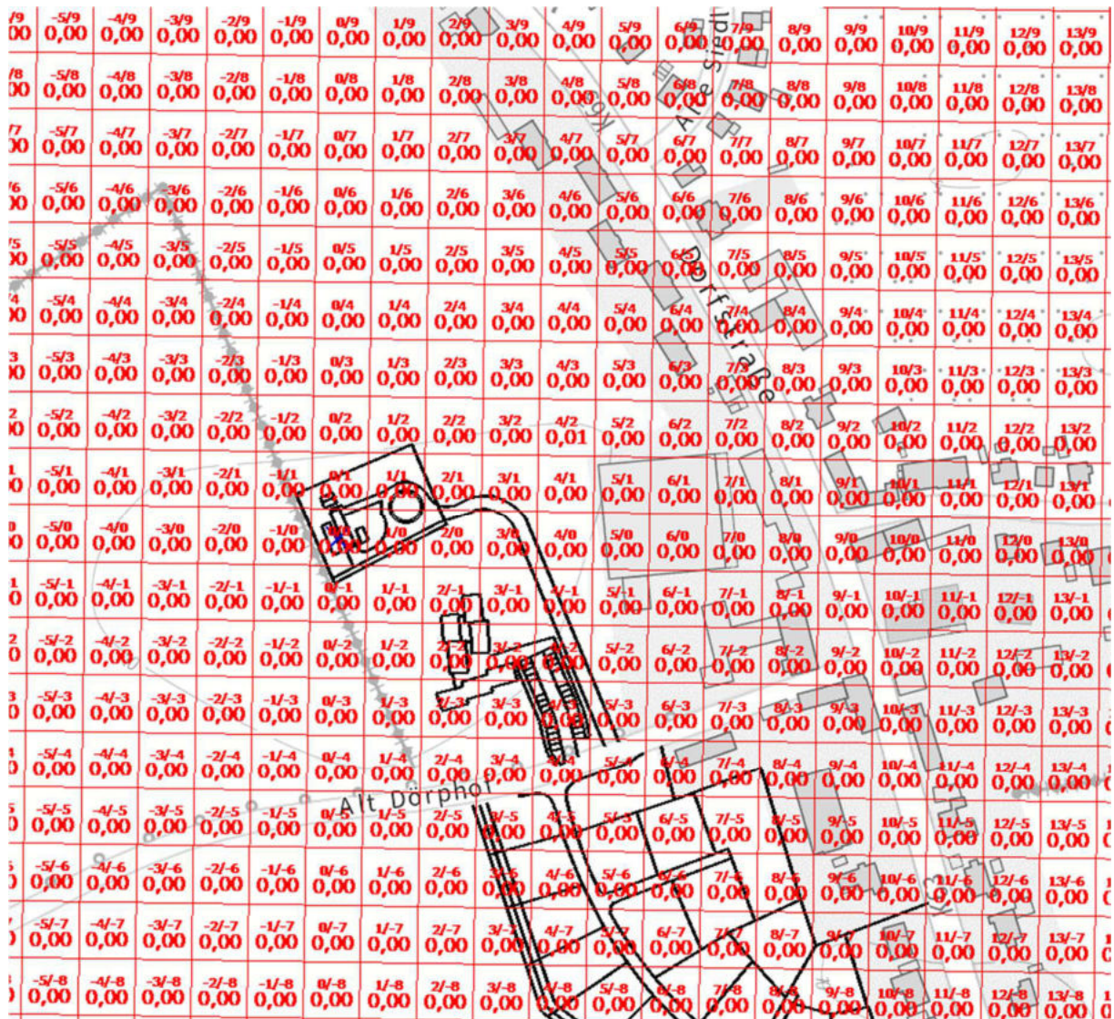
Abbildung 10: Gesamtzusatzbelastung der Geruchsimmissionen Maßstab ca. 1 : 3.000; Gitterraster 25 m x 25 m Karte: onmaps.de ©GeoBasis-DE/BKG/ZSHH 2024; powered by geoGLIS GmbH & Co. KG
