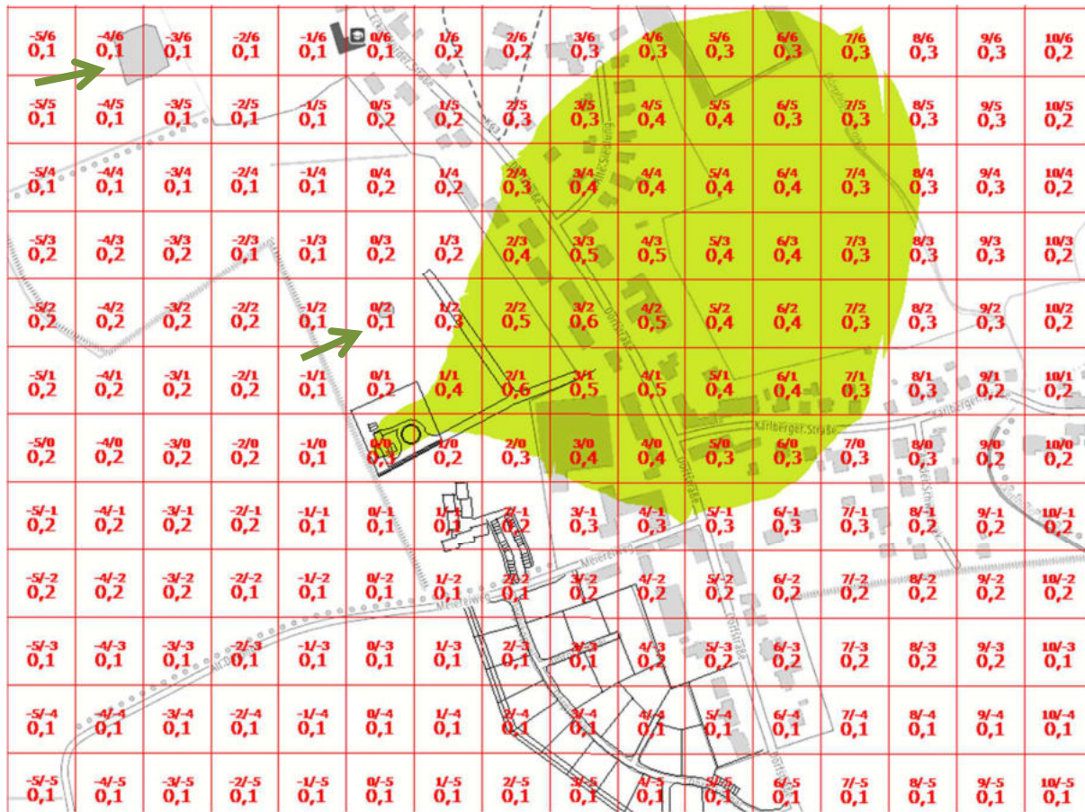
Abbildung 11: Stickstoffdeposition in Kilogramm Stickstoff je Hektar und Jahr im Planzustand (Gesamtzusatzbelastung), Ableitungshöhe 18 m über Flur genordnete Karte; Maßstab ca. 1 : 5.000, Gitterraster 50 m x 50 m Kartengrundlage: © GeoBasis-DE/LVermGeo SH/CC BY 4.0 https://umweltanwendungen.schleswig-holstein.de/fachauswertungweb/q/4LEdNAXKVytBI2SY5OJTzP
