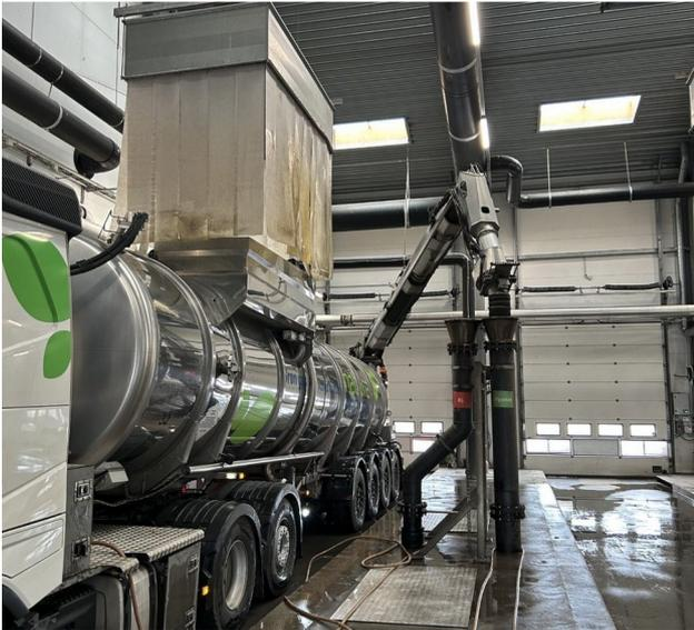
Abb. 3: Beispiel Gülleabtankung (Quelle: Niersberger Wohn- und Anlagenbau GmbH & Co. KG)
