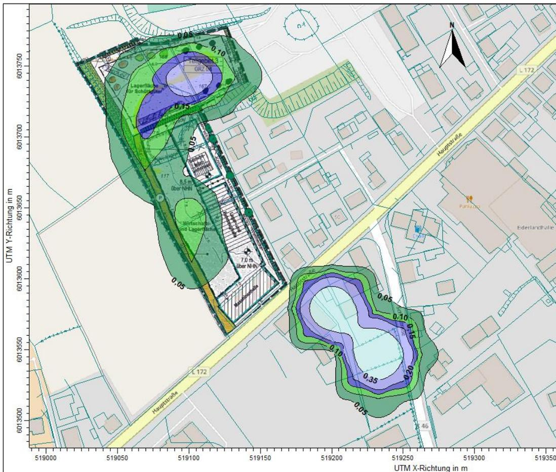
Abbildung 7.4: Ergebnisdarstellung Staub - Gesamtzusatzbelastung Plan-Zustand - Deposition (Staubniederschlag in  $\text{g}/(\text{m}^2 \cdot \text{d})$ ) - BC- P23007-GZP2
