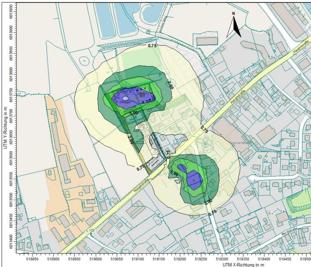
Abbildung 7.2: Ergebnisdarstellung Staub (Partikel PM<sub>2,5</sub>) - Gesamtzusatzbelastung im Plan-Zustand - Isolinen Staubkonzentration (in µg/m<sup>3</sup>) - BC- P23007-GZP2
