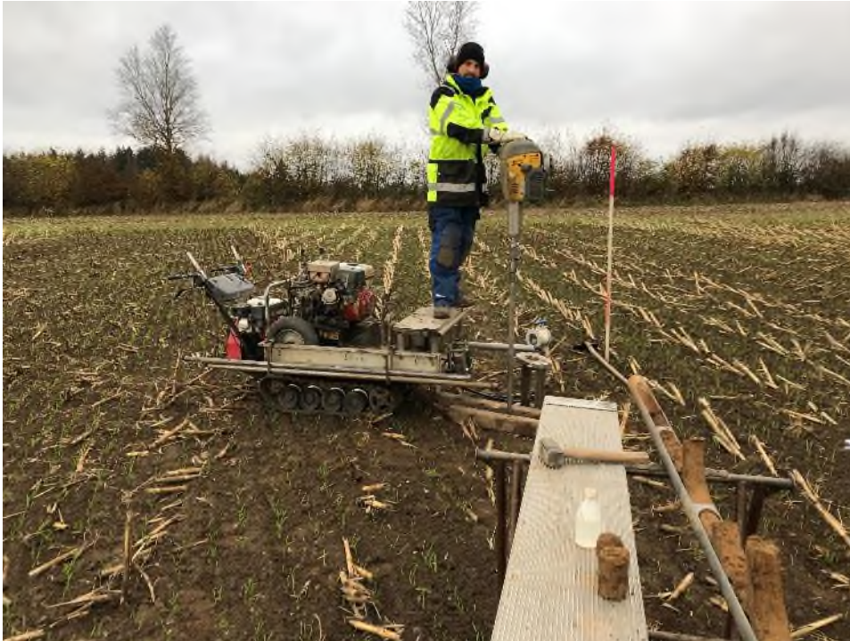
Abb. 3: Durchführung der Bohrsondierung BS 01
