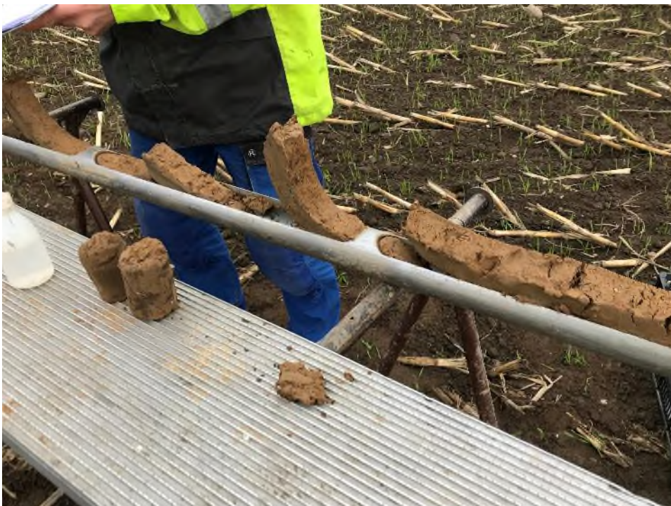
Abb. 4: Erbohrter steifplastischer Geschiebelehm bei BS 01
