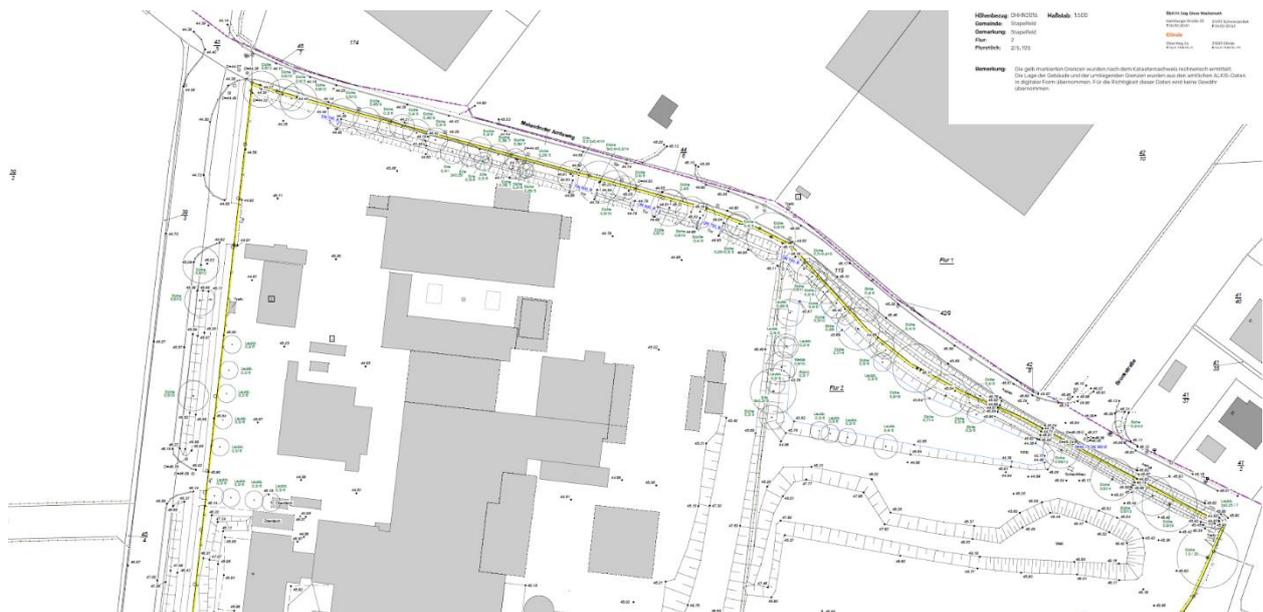
**Abbildung 11: Ausschnitt aus der Vermessergrundlage mit Darstellung der Überhälter**
