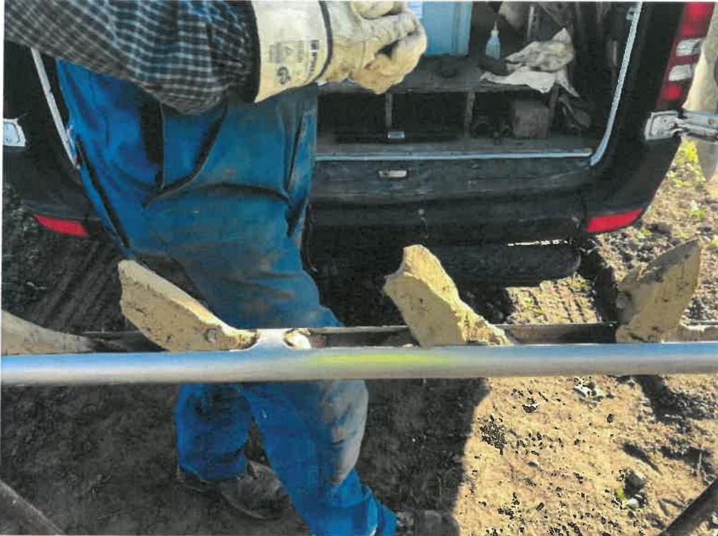
Abb. 5: Erbohrte Bodenschichten (Geschiebemergel, steif) in BS 02
