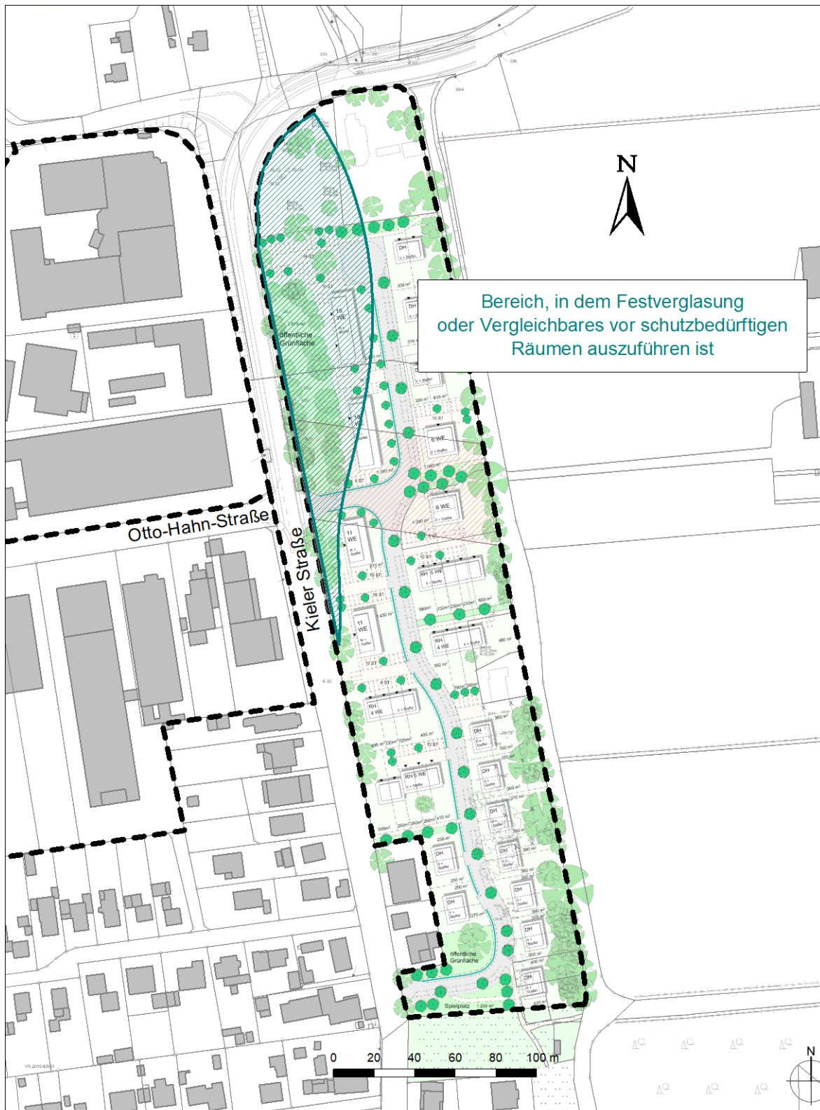
Abbildung 3: Darstellung des Bereiches, in denen festverglaste Fenster vor schutzbedürftigen Räumen erforderlich sind
