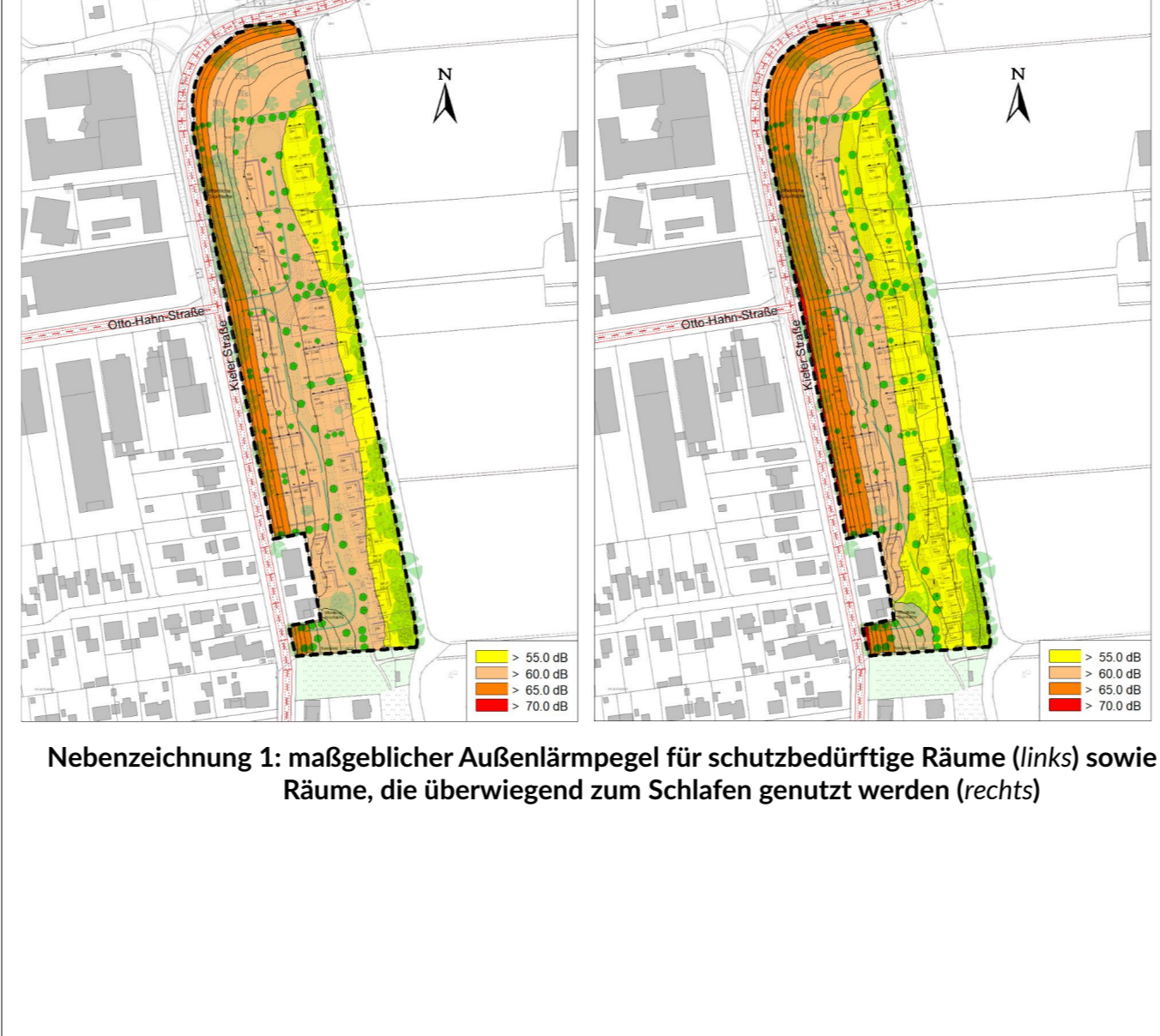
Nebenzzeichnung 1: maßgeblicher Außenlärmpegel für schutzbedürftige Räume (links) sowie Räume, die überwiegend zum Schlafen genutzt werden (rechts)
