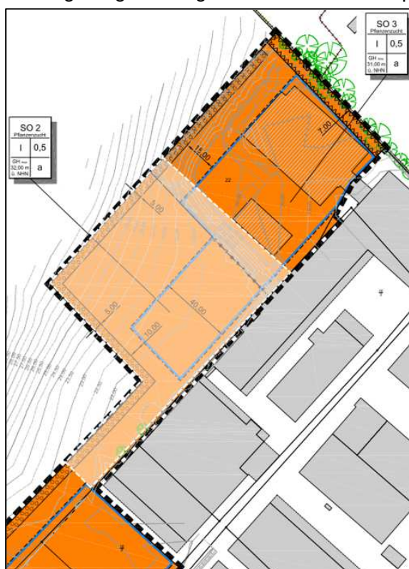
Abb. 11: Bereich mit kompensationsrelevanten Bodenbewegungen im Umfeld der Baumaßnahmen
