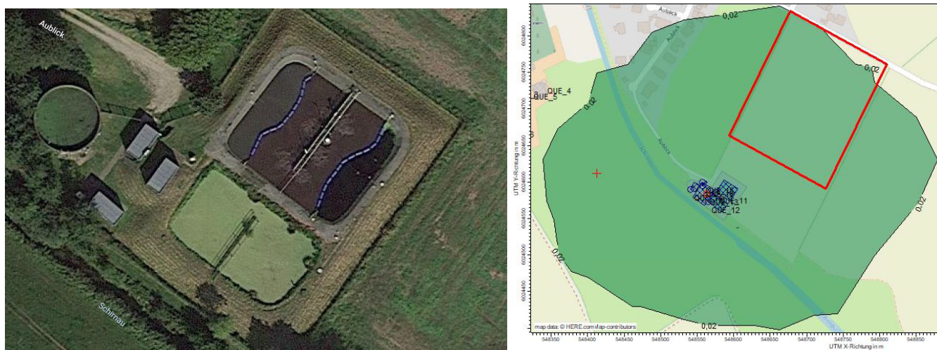
Abbildung A.4. 4: links: Luftbildausschnitt [Stand googlemaps 01.2024]; rechts: Einwirkungsbereich - Geruch - der Anlage; rote Umrandung: Plangebiet [BC-P23087-003]
