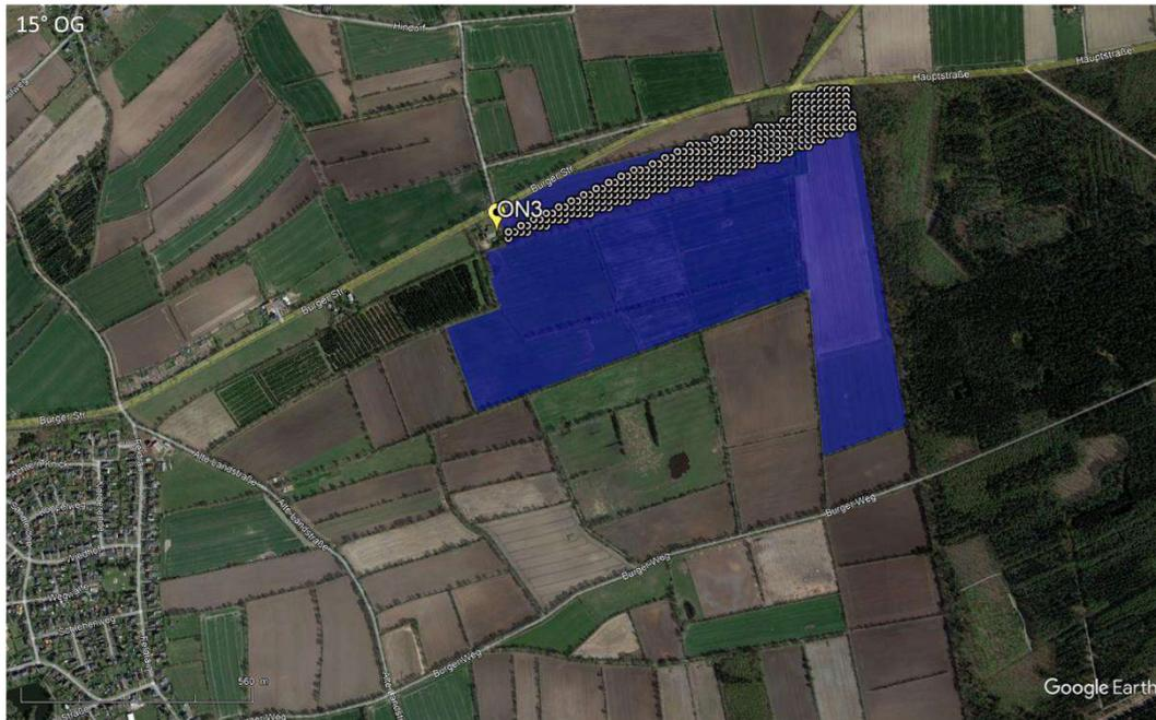
Abbildung 10: Spezifischer Emissionsbereich für Punkt ON3 OG bei 15° Modulneigung
