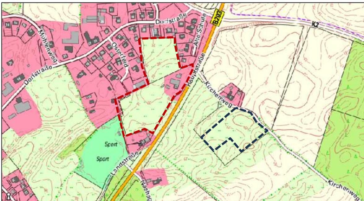
**Abb. 10:** Lage der Entwässerungsanlagen (Graben, Retentionsraum)
