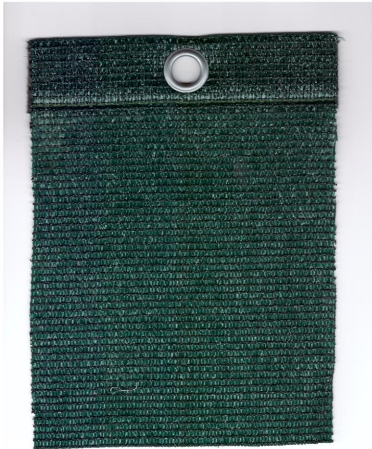
Bild 7: Untersuchtes Kunststoffgewebe, Lieferant Fa. evia Verkehrstechnik GmbH/ACCURA NTV KG Maßstab: ca. 1:2
