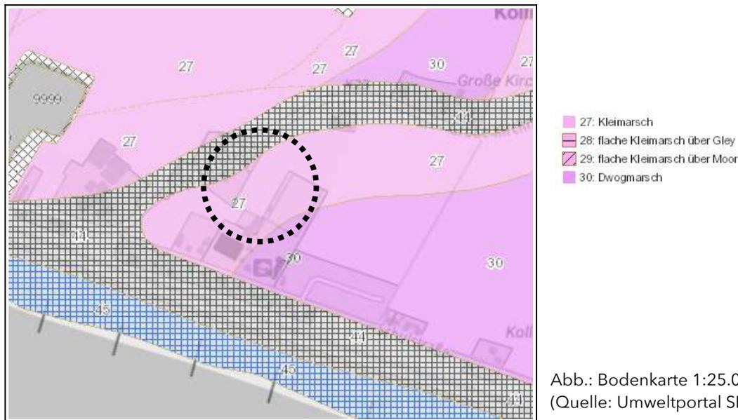
Die anstehenden organischen Weichschichten aus Klei und ggf. überlagernde schluffige Sande sind laut Baugrundgutachten wenig durchlässig bis nahezu undurchlässig und somit für eine Versickerung nicht geeignet.
