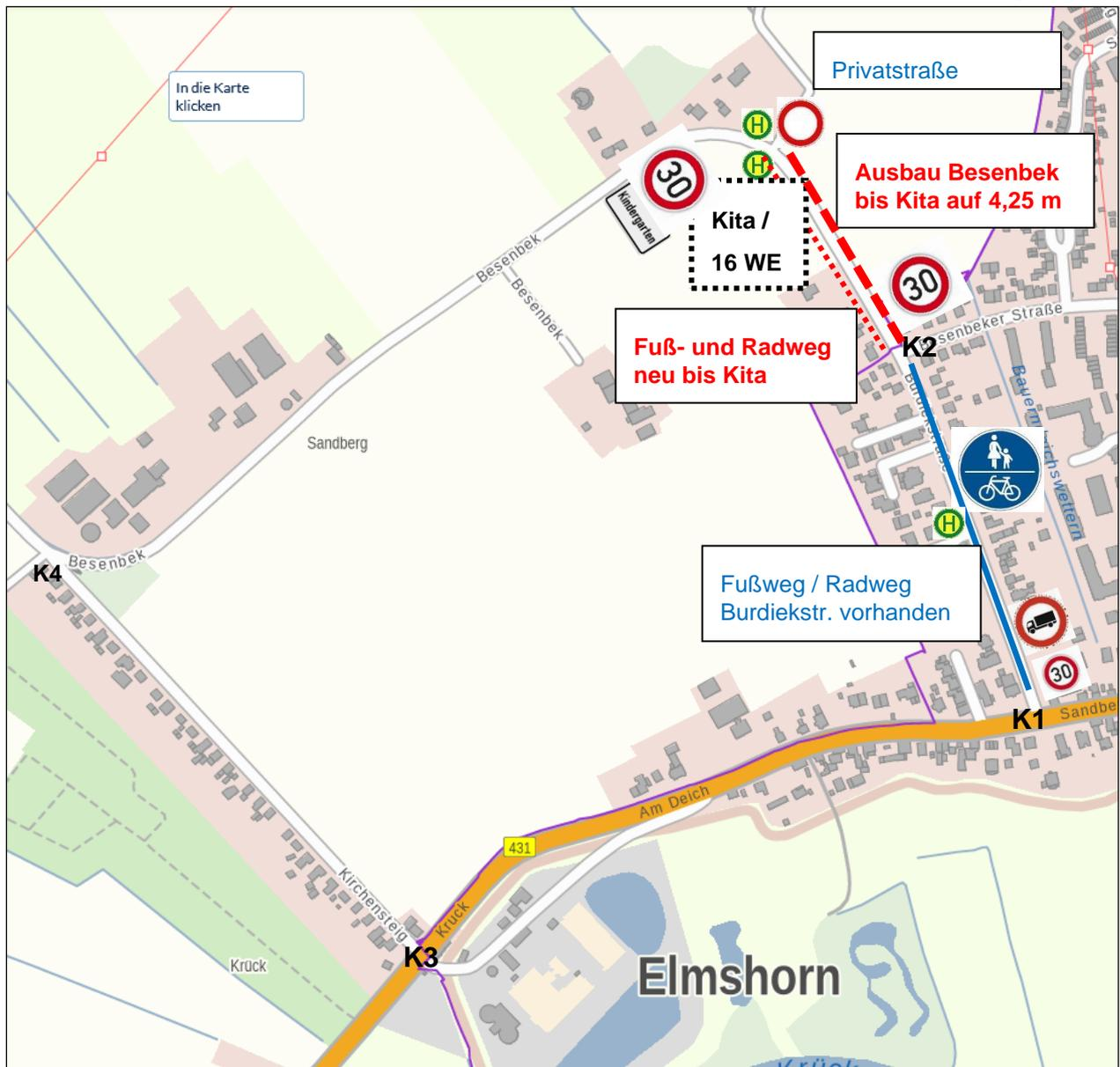
Abb.: Maßnahmenübersicht und Verkehrszeichenplan<sup>7</sup> (Maßnahmenvorschläge in rot)
